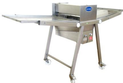
Die Anlage verfügt über eine Spezial-Laugpumpe und eine Laugenschwallleiste. Die Auflagebleche für die Brezelbleche sind hochklappbar. Durch den Spezial-Ablasshahn lässt sich die Lauge bequem ablassen.
